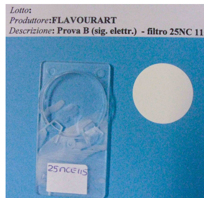
Fig. 4: Membrana in PTFE al termine della sessione di fumo elettronico. / PTFE membrane at the end of the e-cigarette session.
