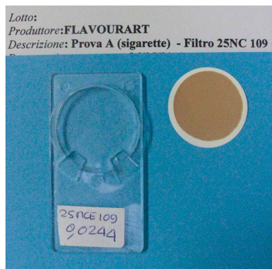
Fig. 3: Membrana in PTFE al termine della sessione di fumo tradizionale. / PTFE membrane at the end of the cigarette smoking session.
