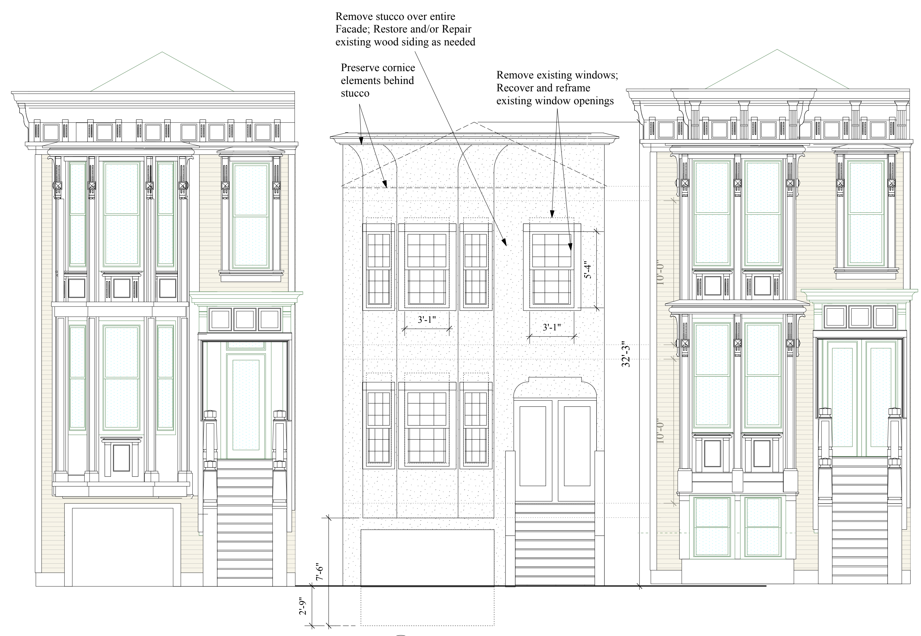
C FRONT ELEVATION - Existing A4 Scale: 1/4" = 1'-0"
