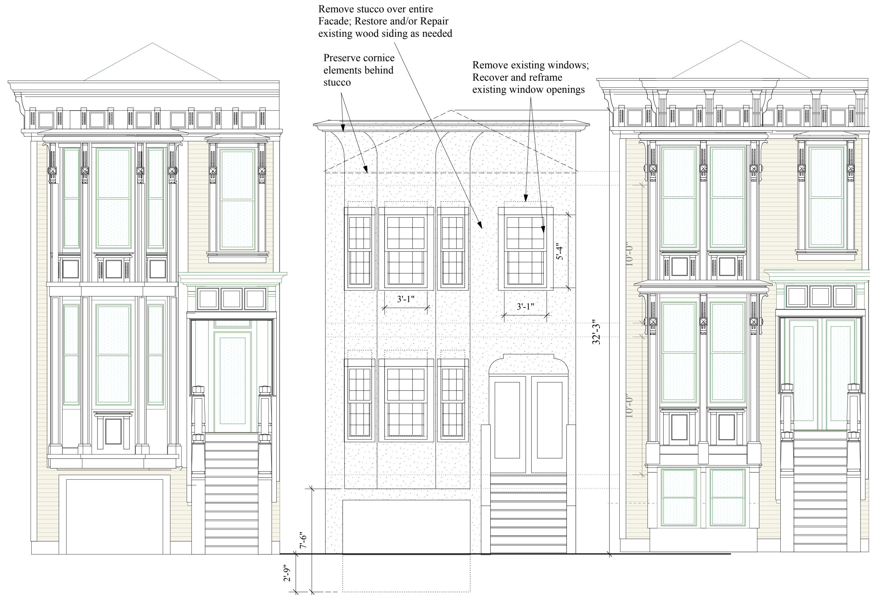
C FRONT ELEVATION - Existing A4 Scale: 1/4" = 1'-0"
