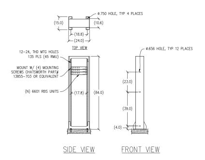
19" SEISMIC RACK W/ 6601 DETAIL
